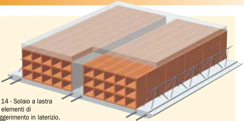
Fig. 14 - Solaio a lastra con elementi di alleggerimento in laterizio.
