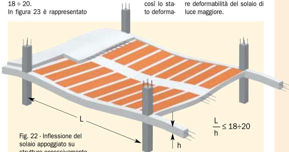
Fig. 22 - Inflessione del solaio appoggiato su strutture eccessivamente deformabili.
